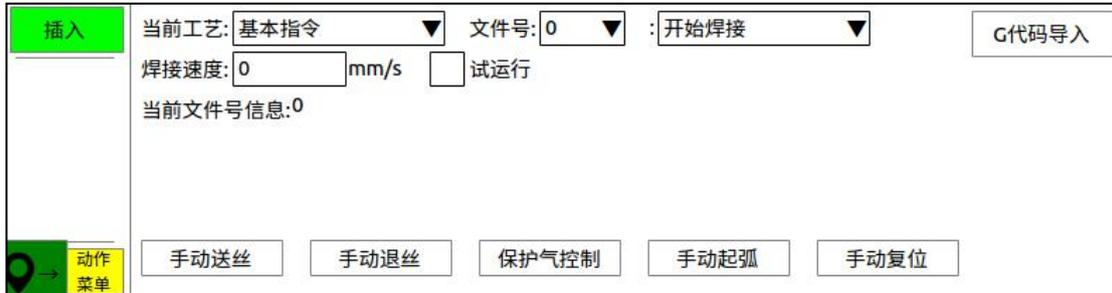
在当前工艺一栏选择想要插入的指令，工艺需要对应已经设置完参数的文件号，否则会导致焊接功能不能正常运行。开始和结束焊接需对应相同文件号，防止参数不匹配。
